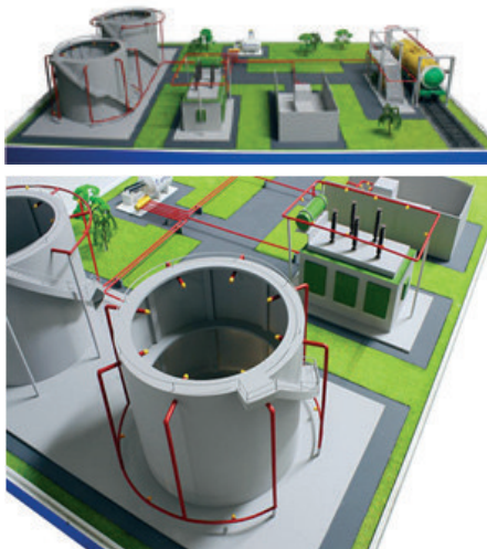
Рис. 3. Возможные варианты построения противопожарной защиты на базе МИЖУ нефтеналивных эстакад, резервуаров с нефтепродуктами, трансформаторов
