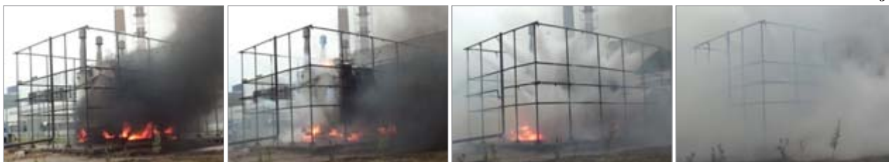
Рис. 2. Кадры видеосъемки трех различных натуральных испытаний на 3, 6, 9 и 12-й секундах (слева направо) подачи CO 2 с момента открытия запорно-пускового устройства МИЖУ
