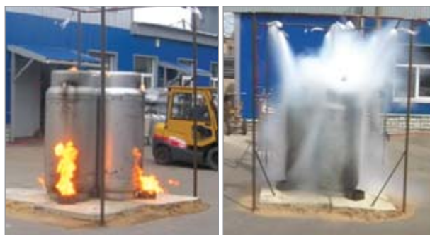
Рис. 1. Тушение УГП на базе двух МГП с вместимостью баллонов 100 л локальным по объему способом макета оборудования, установленного вне помещения
