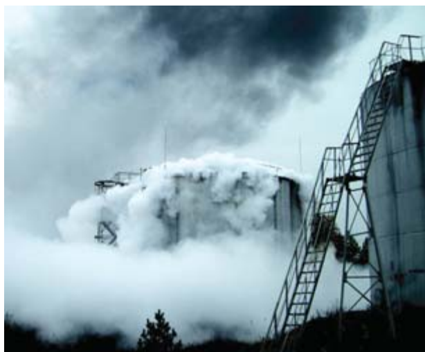
Рис. 2. Состояние пожара в РВС на 30-й секунде после закрытия ЗПУ МИЖУ
